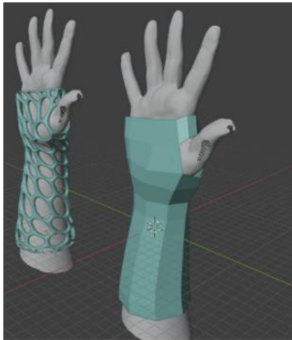
Figura 5. Comparación del modelo escaneado y el modelo CAD.
