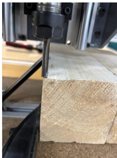
Figura 2. Proceso de mecanizado CNC.
