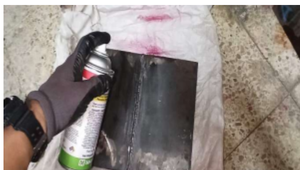
Figura 6. Aplicación del revelador a la placa.
